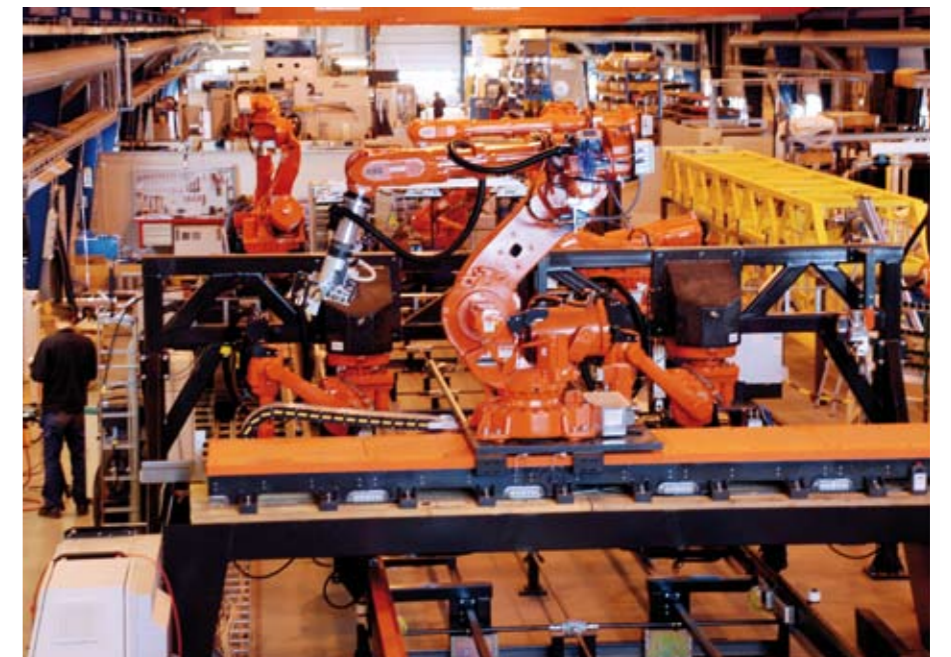
Roboter sentralt i produksjon av bygningsmoduler
