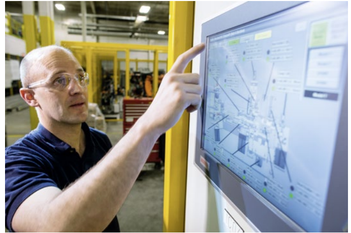
Die Steuerung der Montagezelle erfolgt am Panel-PC CP6202 mit 15"-Bildschirm
