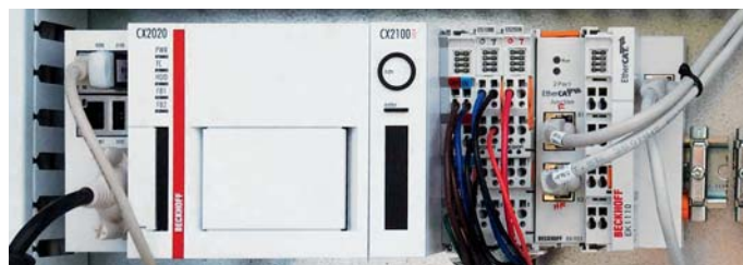
Ein Embedded-PC CX2020 mit TwinCAT NC I für Motion Control und CNC dient als integrierte Steuerungsplattform für SPS und Bewegungssteuerung.
