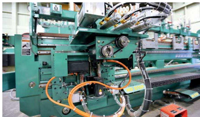
Mit der Commander™ 3 hat KVAL eine neue Maschinengeneration auf den Markt gebracht, die für schnellen Werkzeugwechsel und vielseitige Tür- und Türangel-Routing-Funktionalitäten ausgelegt ist, und sich damit optimal für kleine Losgrößen eignet.
